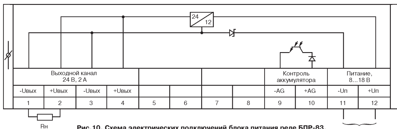
Рис.10. Схема электрических подключений блока питания реле БПР-83.
