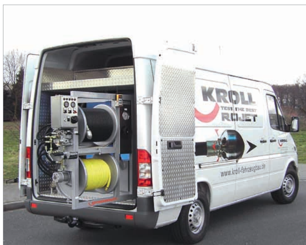
Комфортное исполнение - поворотный держатель для барабана
