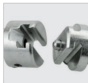
Муфта с Т-образным пазом, скосы облегчают сцепление
