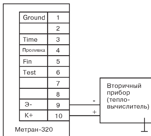
Рис. 1. Схема подключения преобразователя Метран-320 к вторичному прибору.
