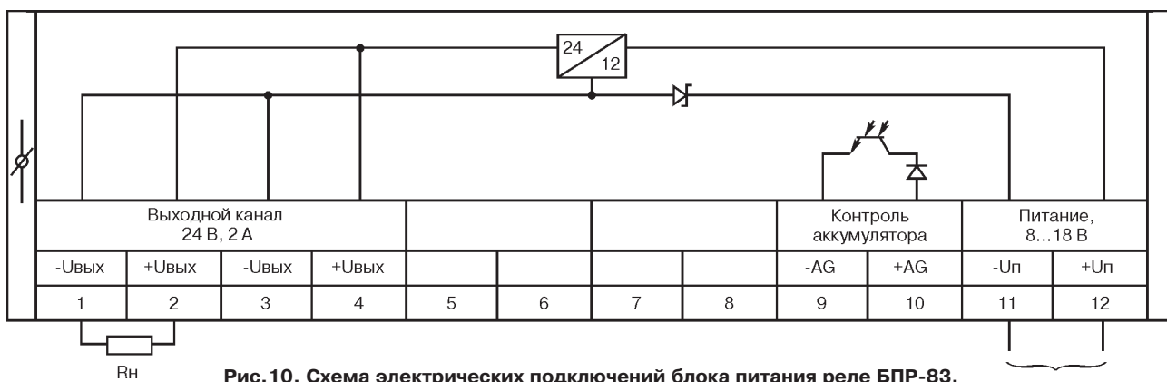
Рис.10. Схема электрических подключений блока питания реле БПР-83.
