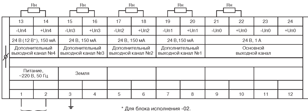
Рис.8. Схема электрических подключений блока питания БП-63, БП-63-02.
