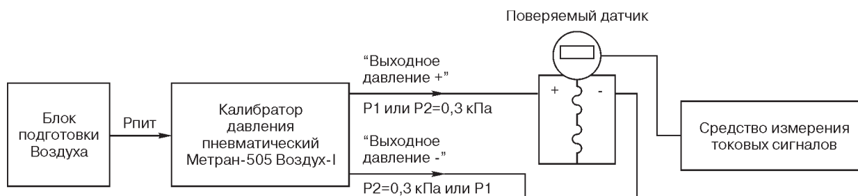
Рис.4. Схема подключения калибратора Метран-505 Воздух-I при поверке датчиков разности давлений с использованием БОД.
