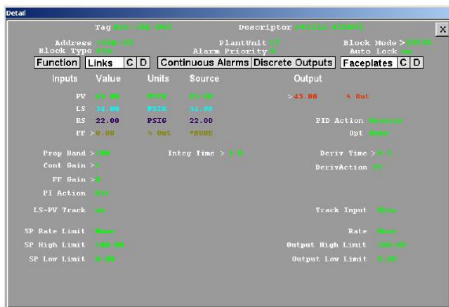
Детальный экран DeltaV для блоков управления RS3
