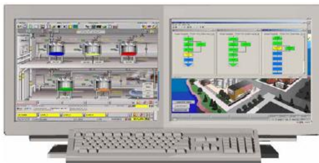
Просмотр хода ABC Batch процесса во время просмотра экранов процесса. Выбор экрана может быть изменен простым нажатием «мыши».
