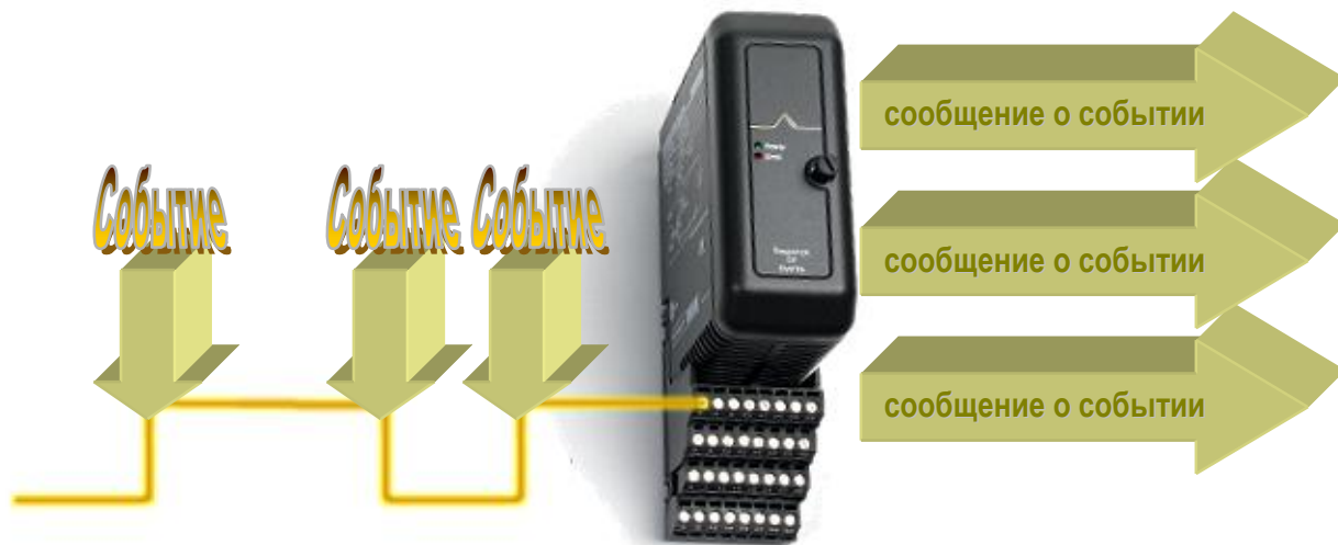
Рисунок 1 Поведение входного сигнала определяет, будет ли плата ввода РПС вырабатывать сообщение о событии.
