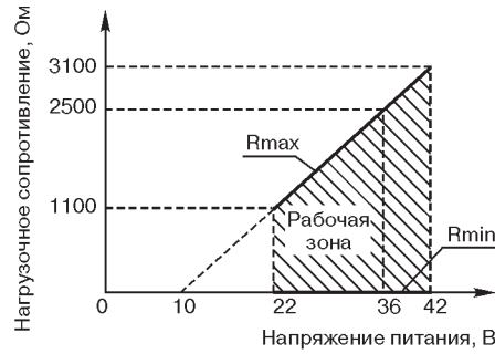
Рис.2. Для датчиков с кодом МП, МП1 (выходной сигнал 0-5, 5-0 мА).
