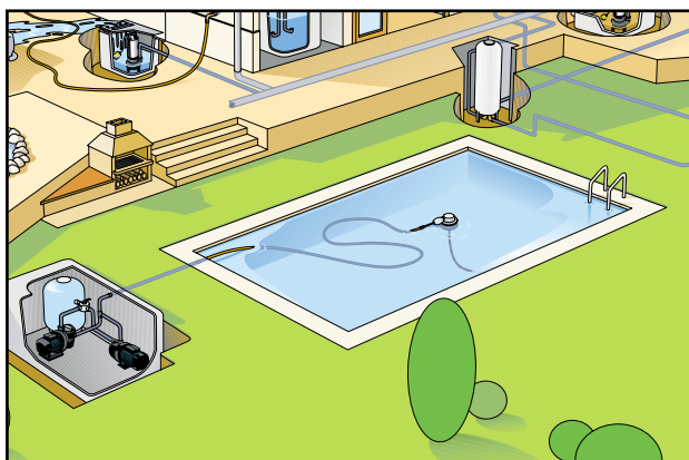
Циркуляция и очистка воды в бассейнах
